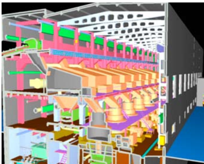
Рис. 1. Разрез корпуса мелкого дробления
